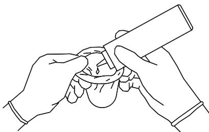
2. Inserte el transductor en la funda y asegúrese de usar la técnica de esterilización adecuada. Tire de la cubierta con fuerza en la superficie del transductor para eliminar pliegues y burbujas de aire, y evite perforar la cubierta.
