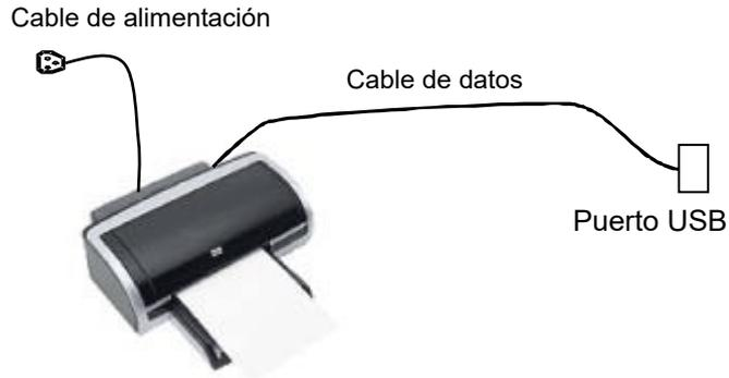
1. Conecte el cable de datos al puerto USB del sistema.
