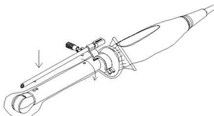
3. Cuando la pinza de retención está girada en la posición correcta, la tuerca de cierre bloqueará la presilla de retención y el soporte de guía por aguja queda montado en la posición apropiada.
