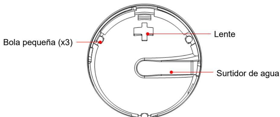
Si se pulveriza líquido sobre el área de la bola de seguimiento, la mayor parte del líquido puede salir por el surtidor de agua y además puede secar el agua que quede con un paño.
