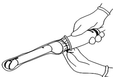
2. Abra la presilla de retención, alinee el soporte de guía por aguja con el transductor para situar la protuberancia de fijación en la guía de la aguja en las ranuras de fijación de la sonda y después, gire la presilla de retención para hacerla coincidir con el transductor a sonda.
