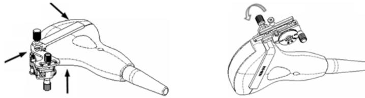
3. Enrosque la tuerca de fijación del soporte de guía por aguja para asegurarse de que dicho soporte esté correctamente instalado en el transductor.
