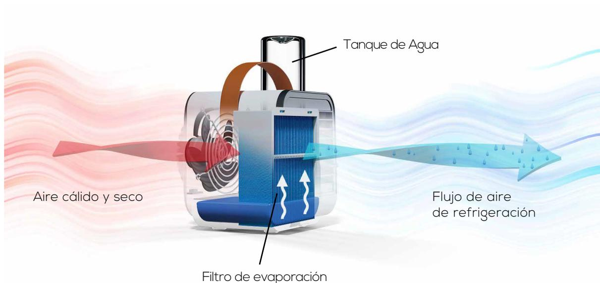
El ventilador aspira el aire cálido y seco de la habitación, que entra en contacto con el filtro de evaporación saturado de agua. El contacto entre el flujo de aire y el filtro húmedo hace que el agua se evapore. El aire del ambiente absorbe la humedad y la energía necesaria para la evaporación lo que genera una notable baja de temperatura en el ambiente..
