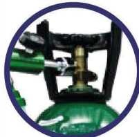
Entrada de válvula
