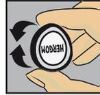
Examine visualmente el aro para asegurar que el borde flexible esté perfectamente enganchado dentro del aro. Si es necesario, doble el conjunto pellizcando la orilla exterior del aro entre el pulgar y los demás dedos. Repita esta operación de flexión después de girar el conjunto un cuarto de vuelta.
