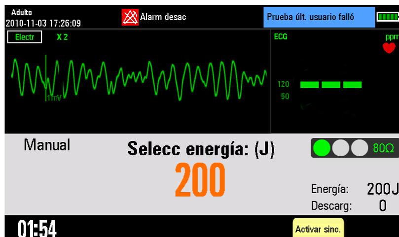
En el área ECG ampliada, se muestra una onda ECG y los parámetros relacionados. En el centro de la pantalla, se muestran el modo de desfibrilación, el icono de sincronización, los mensajes de indicación, la energía seleccionada, el indicador de impedancia de contacto (configurable) y un contador de descargas.
