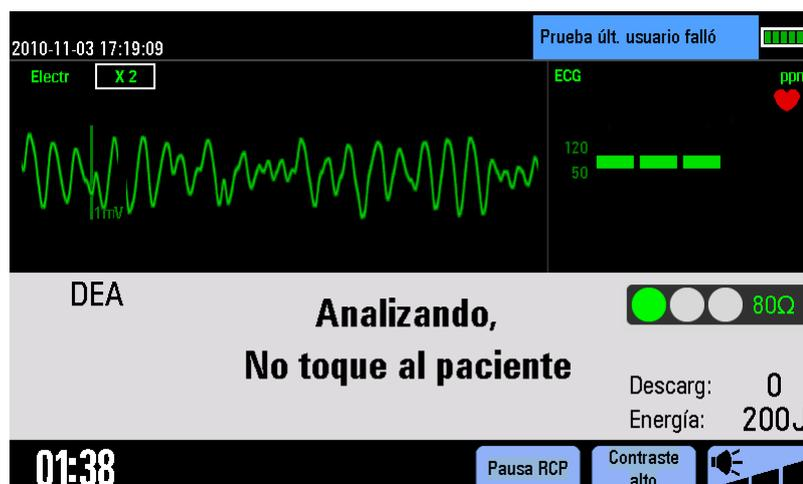
En este modo se muestran los valores de FC y una onda de ECG adquirida desde los electrodos multifunción. Debajo del ECG se encuentra el área de información, en la que se muestran el modo de desfibrilación, los mensajes de indicación, el indicador de impedancia de contacto, la energía seleccionada y un contador de descargas.
