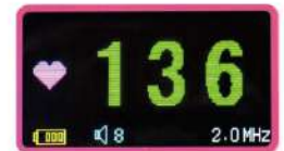
A. Indicador de Batería/Cargador B. Indicador de Volumen C. Frecuencia de trabajo de la sonda del ultrasonido. D. Área de Visualización FCF
