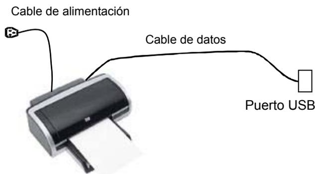
1. Conecte el cable de datos al puerto USB del sistema.
