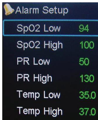
Figura 5.4.3 Menú de configuración de alarma
