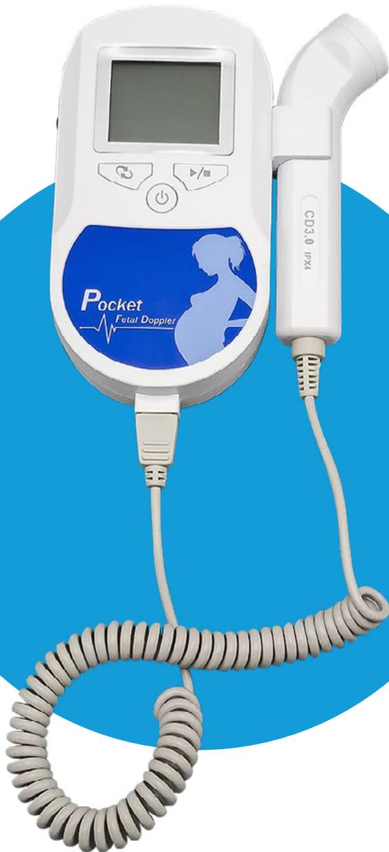
El Doppler fetal de bolsillo DOPBF es un dispositivo portátil de detección de frecuencia cardíaca fetal que adoptó la teoría Doppler. Muestra la frecuencia cardíaca fetal en la pantalla LCD digital. Con una operación fácil y conveniente, se puede utilizar en el hospital y la clínica para la auto-comprobación diaria por parte de la mujer embarazada, realizando un seguimiento temprano y cuidado de por vida.
